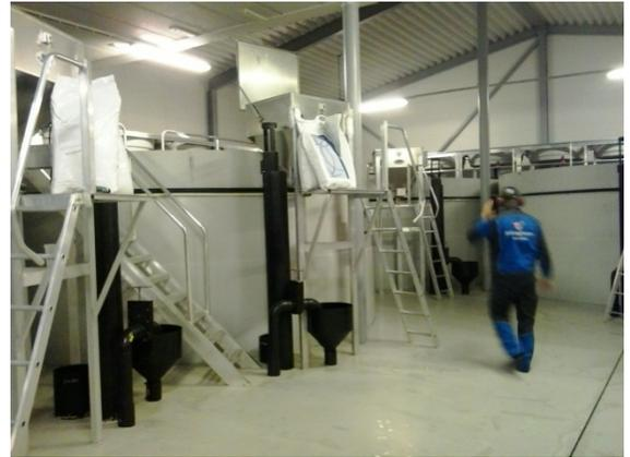
Les bassins sont alimentés par de l'eau provenant de la montagne, chauffée dans une chaufferie, ce qui permet de la passer de 4 à 14°C.
