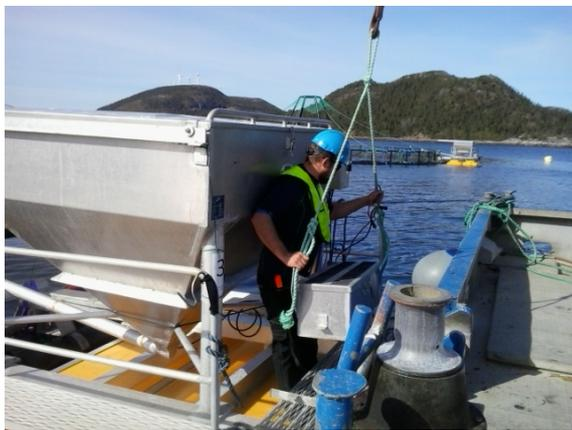
*Changement de la batterie du distributeur automatique avec la grue*
